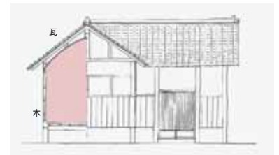
瓦葺、木軸構法による恒久化
